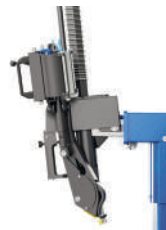
Вспомогательное устройство для монтажа и демонтажа борта шины без использования монтировки
